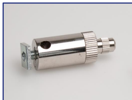
REGELBARE OPHANGING 3 regelbare ophanging met plaatje dat in geul van profiel geschoven wordt voor kabel diam 3mm
